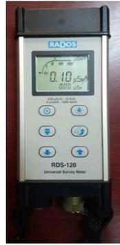
Fig. 2.2. RADOS RDS-120 Survey meter
