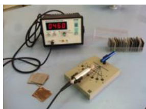
شكل (2) تركيب جهاز عداد جايجر مولر لقياس شدة أشعة جاما.
