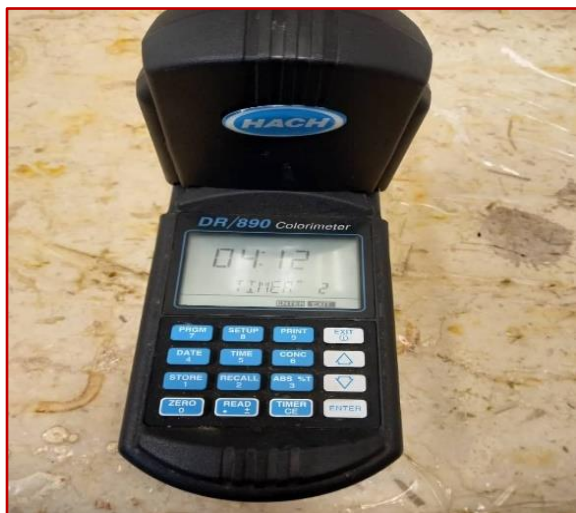
شكل 4. جهاز قياس درجة تركيز أيون النترات لعينات الدراسة جدول 2. حدود متغيرات الدراسة وفقاً للمواصفات المعتمدة [9]
