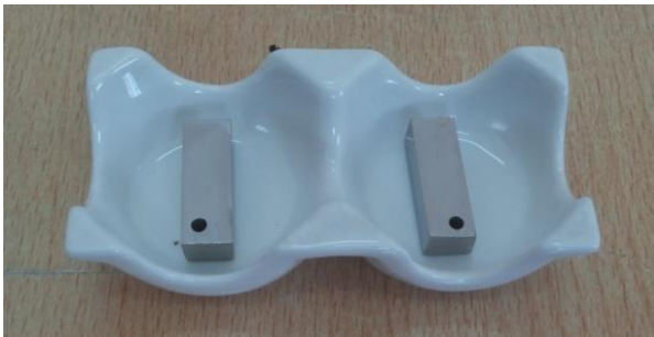
شكل 6 قالب السيراميك المستخدم في المعالجة الحرارية ويدخله العينات
