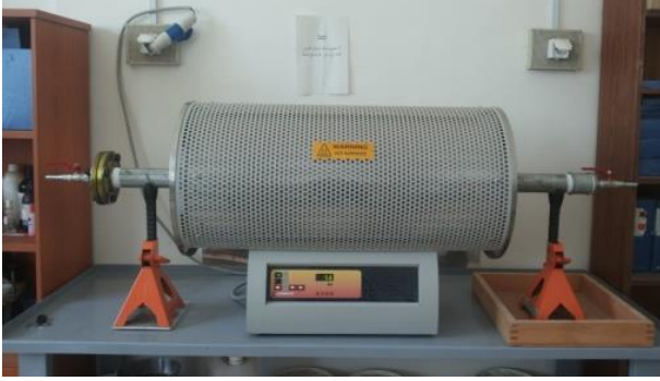
شكل 4 الفرن المستخدم لإجراء المعالجة الحرارية بعد الانتهاء من تجهيزه
