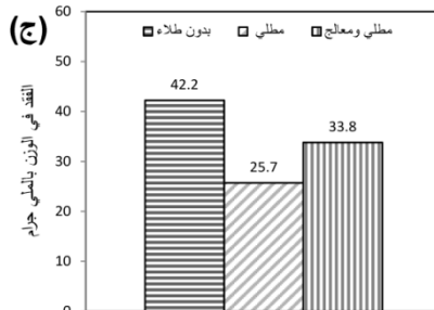
شكل 14 مخططات الفقد في الوزن لعينات التآكل باستعمال محاليل مختلفة التركيز من كلوريد الصوديوم (أ) 1% (ب) 2% (ج) 3%
