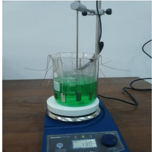
شكل 2 يوضح كيفية وضع العينات في محلول الطلاء
